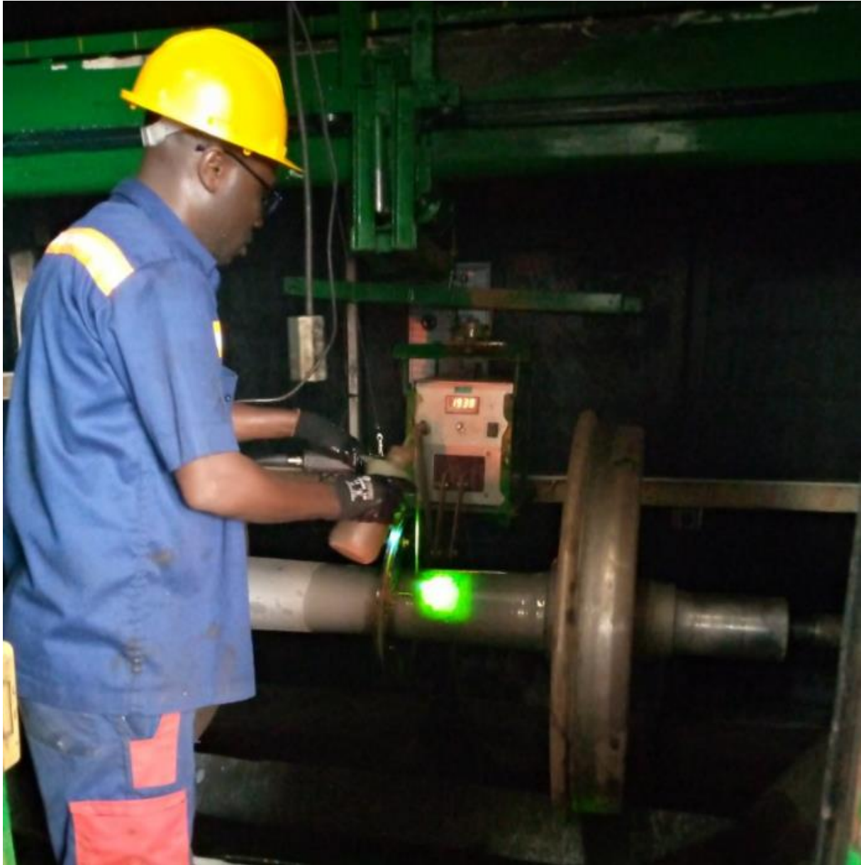
Un cheminot utilisant la magnétoscopie des essieux
