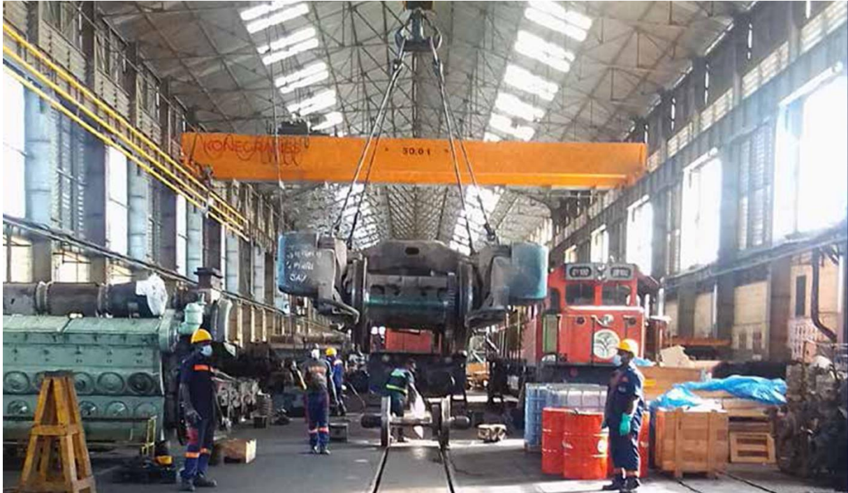
L'entreprise a acquis 3 ponts bi-poutres KONECRANES de 50 tonnes et des matériels accessoires de levage
