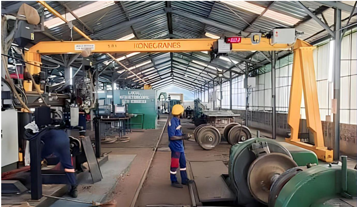
Opérateur manœuvrant le pont à distance
